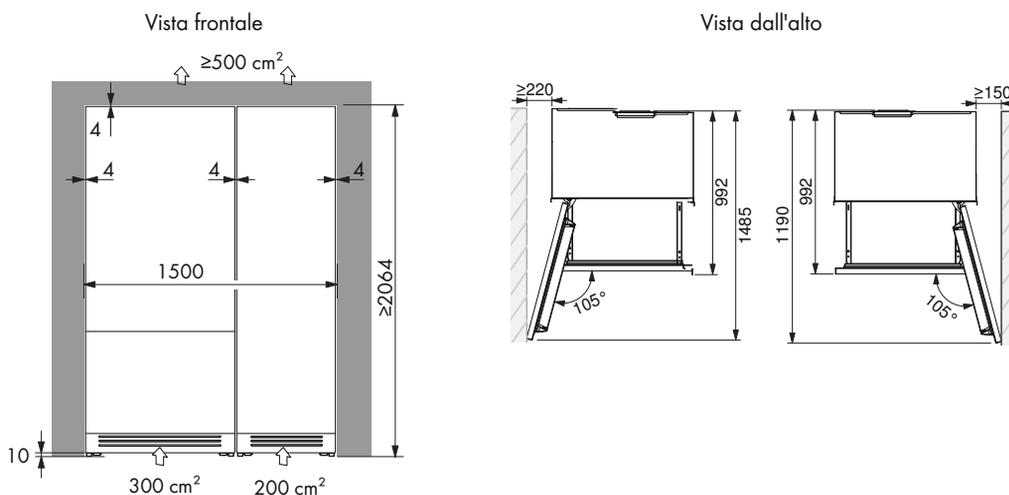
**\*Attenzione:** nella fornitura è incluso uno zoccolo inox; nel caso sia prevista l'installazione di uno zoccolo personalizzato, utilizzare delle calamite per attaccarsi ai magneti presenti sull'apparecchio.
