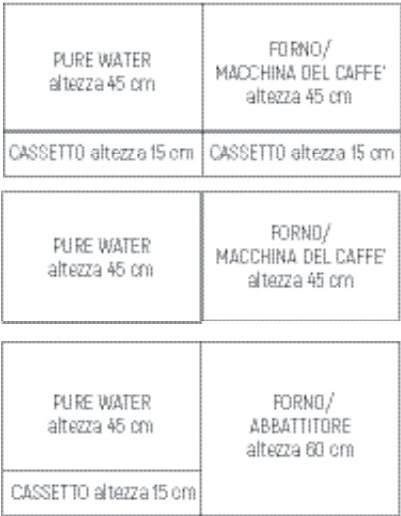
Installazioni possibili affiancate Pure Water/macchina del caffè/forni
