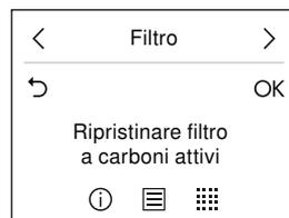
**💡** In alternativa l'allarme di indicazione di saturazione può essere raggiunto anche dal menu «Filtro» della cappa aspirante.
