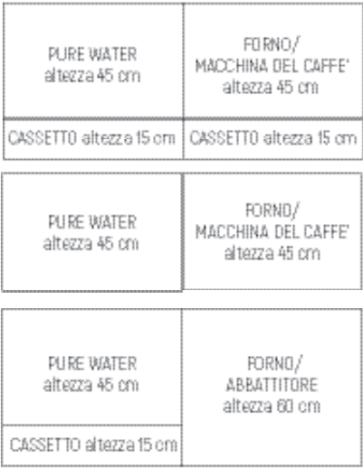
Installazioni possibili affiancate Pure Water/macchina del caffè/forni
