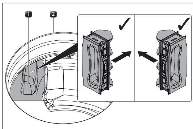
Fig. 6.42 Inserire la valvola di sostituzione del filtro
