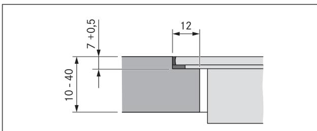
Fig. 6.9 Dimensioni dell'incassatura per montaggio a filo piano
