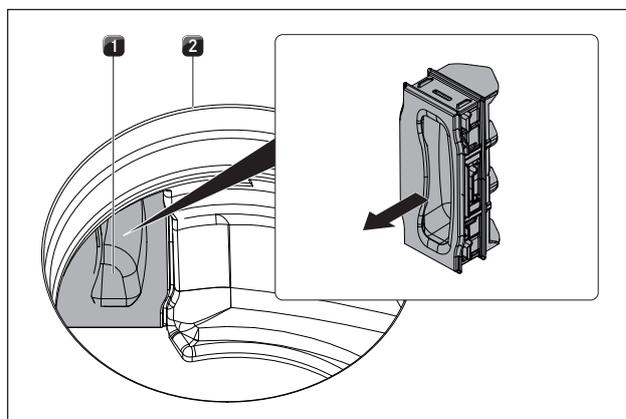
Fig. 6.38 Rimuovere la valvola di sostituzione del filtro
