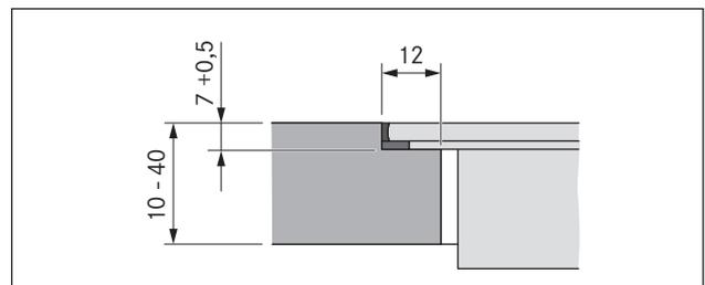
Fig. 6.13 Dimensioni dell'incassatura per montaggio a filo piano
