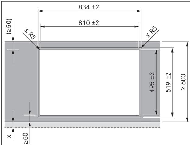
Fig. 6.8 Dimensioni d'intaglio per montaggio a filo piano
