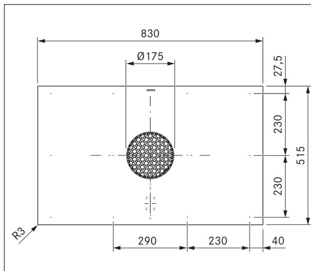
Fig. 3.4 PUXU dimensioni apparecchio visto da sopra
