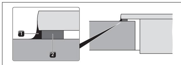
Fig. 6.29 Nastro a tenuta per montaggio in battuta
