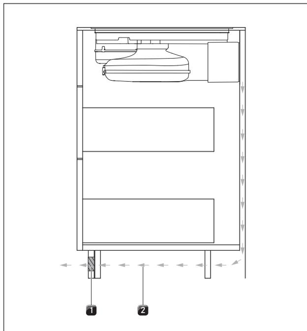
Fig. 6.6 Apertura di sfogo nell'area dello zoccolo
