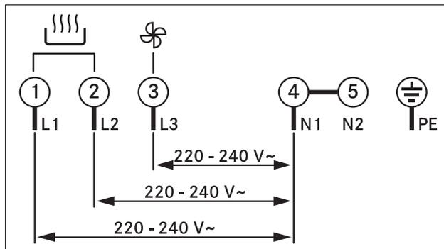
Fig. 6.44 Schema di collegamento connessione a trifase
