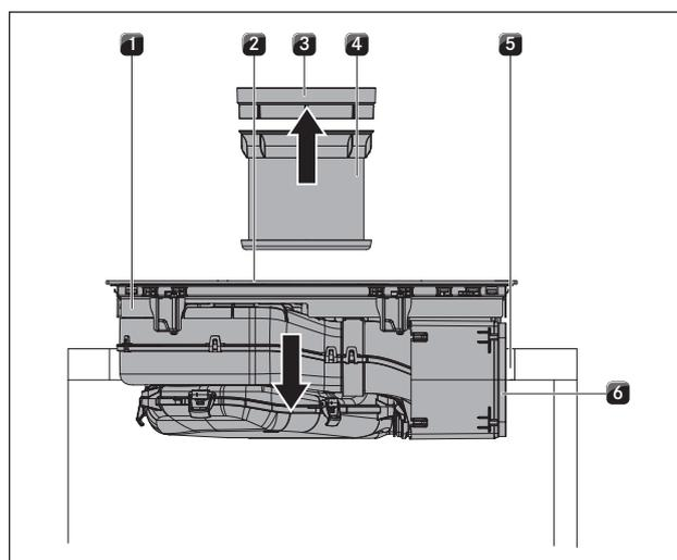
Fig. 6.33 Inserire il piano cottura nel centro
