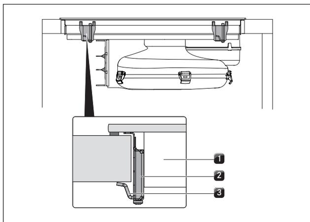
Fig. 6.23 Fissare il piano cottura nel centro
