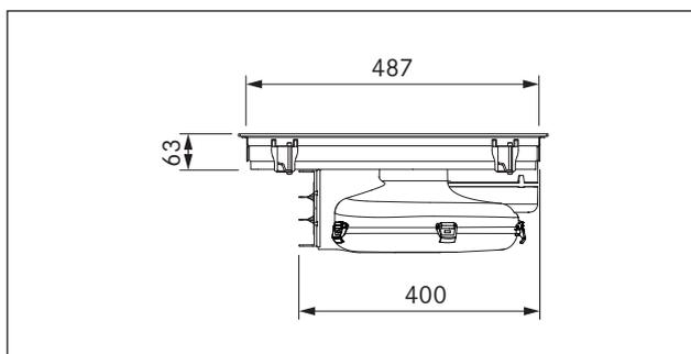
Fig. 3.3 PUXA dimensioni apparecchio visto laterale
