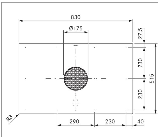
Fig. 3.1 PUXA dimensioni apparecchio visto da sopra
