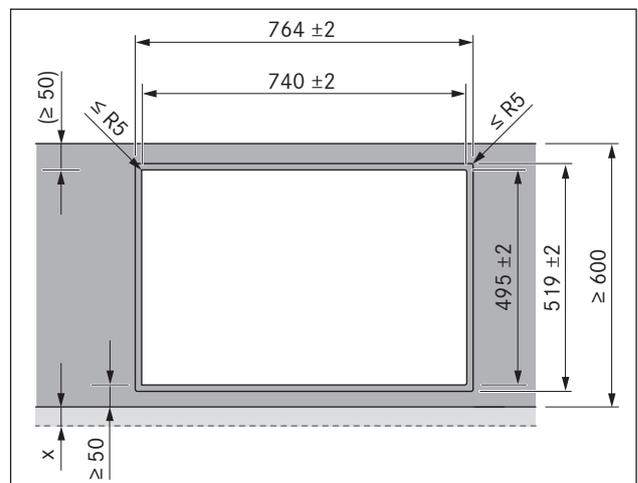
Fig. 6.12 Dimensioni d'intaglio per montaggio a filo piano
