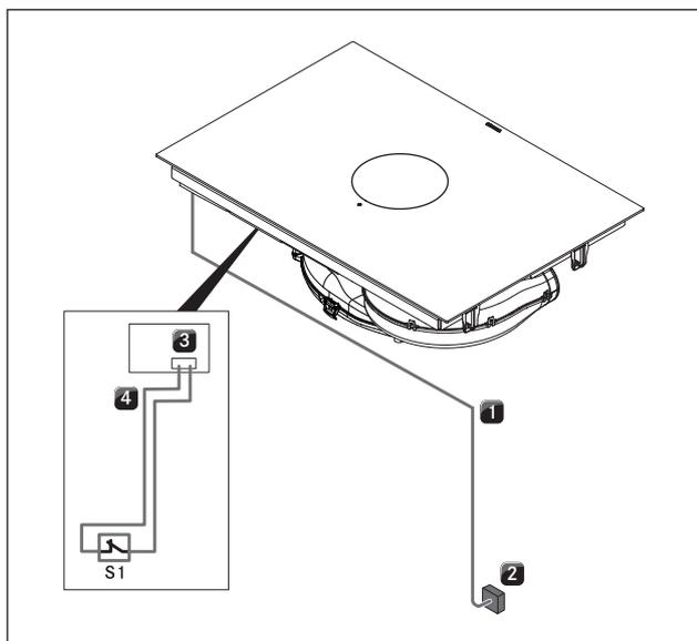
Fig. 6.43 Schema di collegamento con modulo Home-In opzionale
