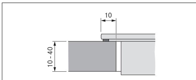
Fig. 6.15 Misura d'appoggio per montaggio in battuta
