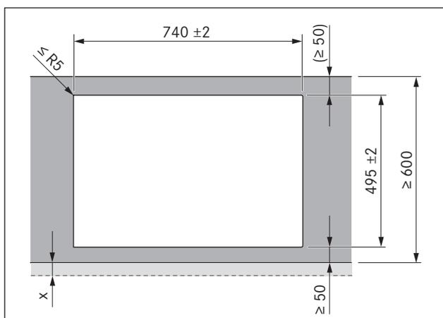
Fig. 6.14 Dimensioni d'intaglio per montaggio in battuta
