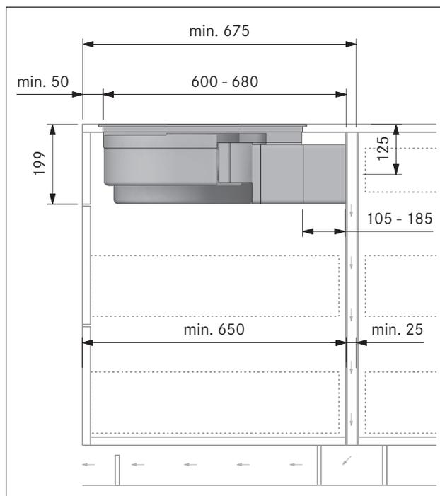
Fig. 6.26 Dimensioni di montaggio con sistema filtrante, profondità piano di lavoro 675 mm
