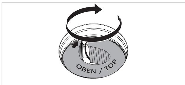
Fig. 8.10 Posizionare il filtro al carbone attivo nella posizione finale
