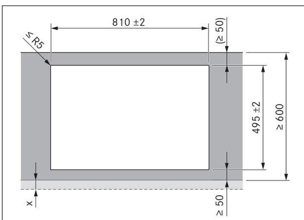
Fig. 6.10 Dimensioni d'intaglio per montaggio in battuta
