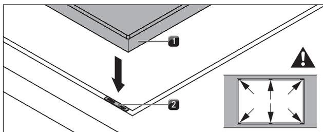
Fig. 6.21 Applicare i pannelli di compensazione altezza
