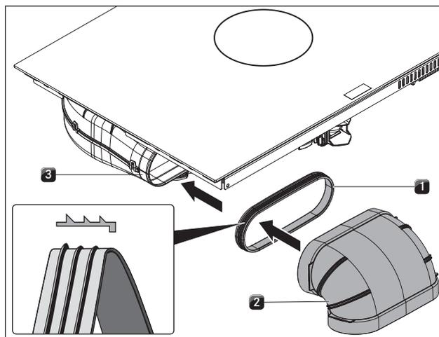
Fig. 6.24 Connessione al sistema di canali
