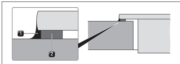
Fig. 6.17 Nastro a tenuta per montaggio in battuta
