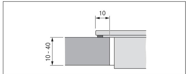
Fig. 6.11 Misura d'appoggio per montaggio in battuta
