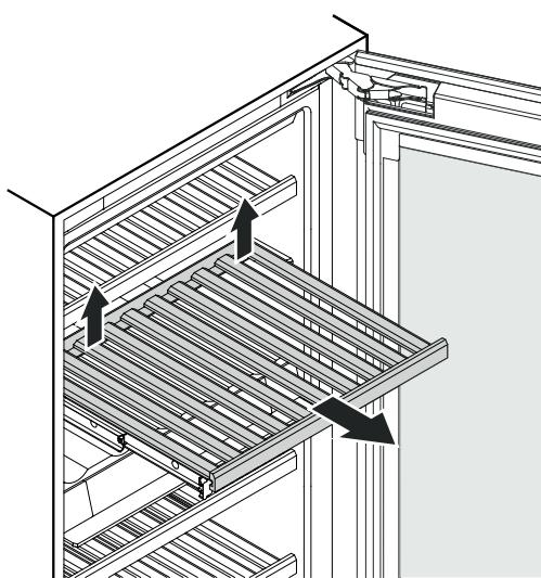
Das Holztablar hinten rechts und links nach oben ziehen (ausrasten) und nach vorne entnehmen.
