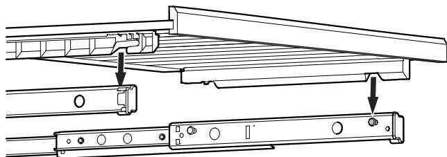
Estrarre completamente le guide di scorrimento. Collocare la mensola in legno con gli alloggiamenti anteriori sui perni di supporto.
