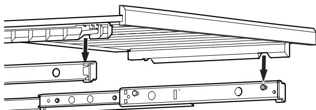
Auszugsschienen ganz herausziehen. Das Holztablar mit den vorderen Ausnehmungen auf die Haltebolzen aufsetzen.
