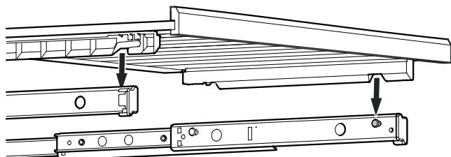
Sortir complètement les glissières télescopiques. Mettre en place la clayette en bois en insérant les encoches situées à l'avant dans les pivots de support.
