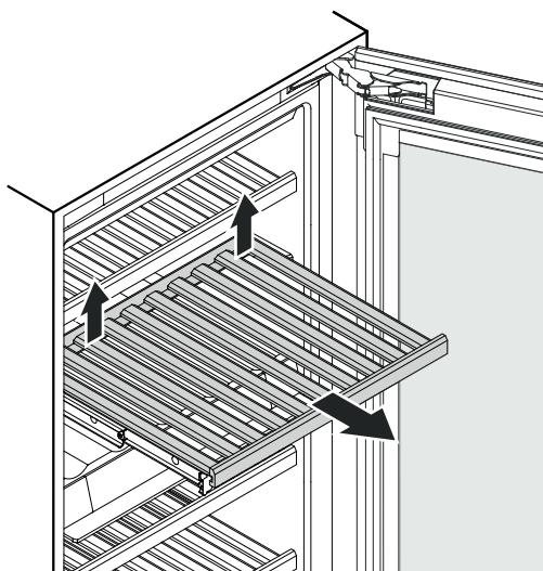
Soulever (désenclipsser) la partie arrière de la clayette en bois à droite et à gauche et la retirer vers l'avant.
