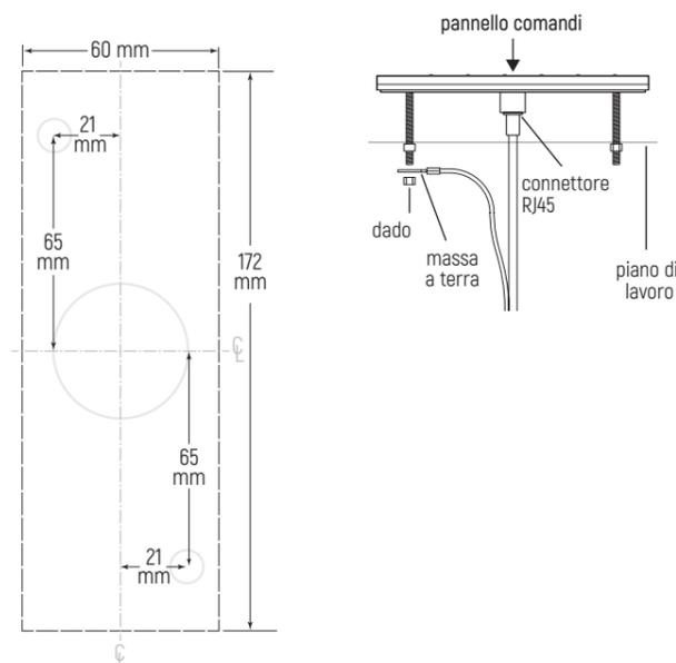
Attenzione: posizionare il pannello comandi a lato del piano cottura ad una distanza di min. 85 mm. La lunghezza del cavo è di 2800 mm.
