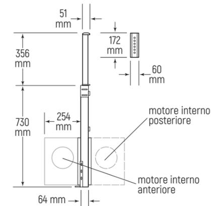
Nel disegno cappa con motore interno e foro uscita fumi Ø 152 mm sul lato frontale (la linea tratteggiata rappresenta il motore interno montato posteriormente).
