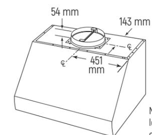
Nella figura sono riportate le dimensioni per lo scarico fumi verticale, fondamentali per la corretta installazione.
