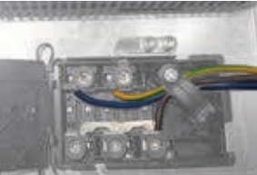
Schema allacciamento elettrico monofase (morsettiera)
