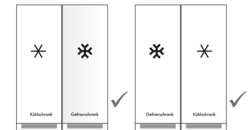
Bei einer Side-by-Side-Installation **müssen die Haushaltsgeräte in zwei separaten Schränken** untergebracht werden. Sorgen Sie für eine angemessene Luftzirkulation von mindestens 200 cm<sup>2</sup> für jedes Gerät im vorderen Sockel und im oberen Bereich des Kühlschranks.
