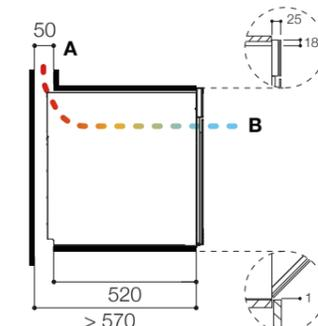
A: Für Umluft ist ein Kanal von Mindestmaß von 50 mm im oberen Teil des Einbaufachs.
