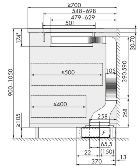
\*170 mm bei aufgesetzter Montage
