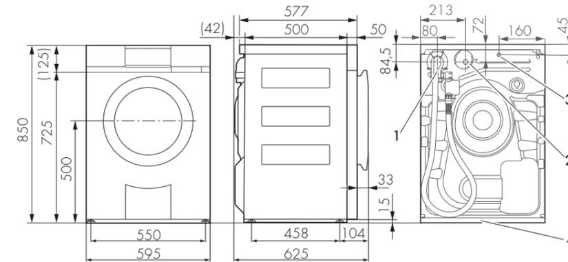
1. Anschluss Kaltwasser; Zulaufschlauch mit Aquastop, Länge: 1,25 m, G $\frac{3}{4}$ "
