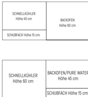
Auf die Dicken der Türen von Schnellkühler und Ofen achten: Bei Säuleninstallationen muss hinter dem Ofen V-ZUG ein 2-3 mm dickes Profil eingesetzt werden, um den
