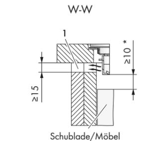
1. Spalten frei lassen für ausreichende Lüftung bei einer Basis 900 mm breit
