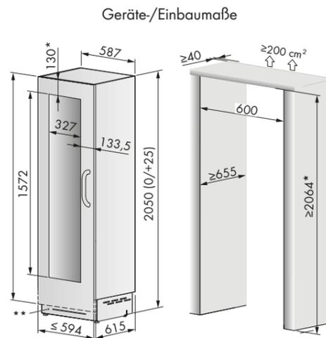
\*= Bei einer Nischenhöhe >2064 muss die Höhe der Verkleidungsplatte angepasst werden
