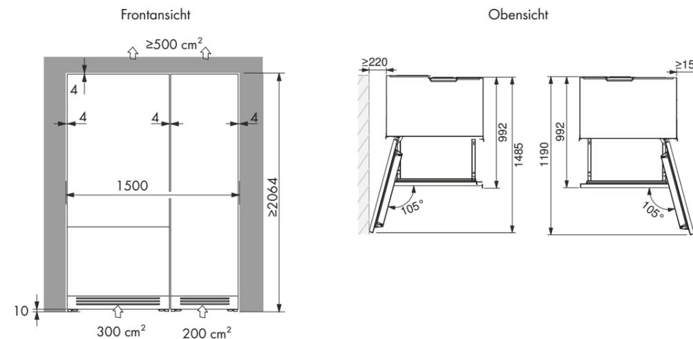
**HINWEIS:** Ein Edelstahlsockel ist im Lieferumfang enthalten. Soll ein kundenspezifischer Sockel installiert werden, verwenden Sie Magnete zum Anhaften an den am Gerät befindlichen Magneten.
