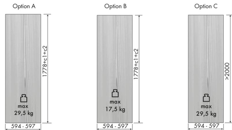
**Option A)** Einzeltürverkleidung für gleichzeitiges Öffnen beider Türen von Kühl- und Gefrierfach.
