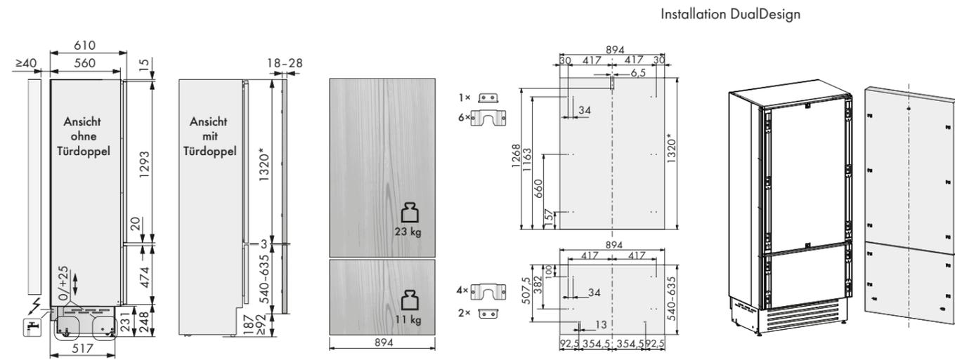
Maximalgewicht Verkleidungspaneele für Türen: 34 Kg
