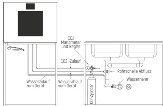
Wichtiger Hinweis: Der Wassereingangsdruck darf weder höher als 5 bar noch geringer als 1,5 bar sein. Übersteigt der Wassernetzdruck die 5 bar, einen Wasserdruckminderer einsetzen.
