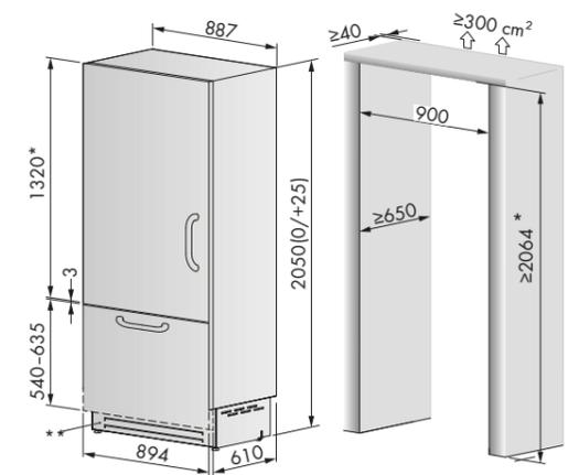
\*Bei einer Nischenhöhe >2064 muss die Höhe der Verkleidungsplatte angepasst werden
