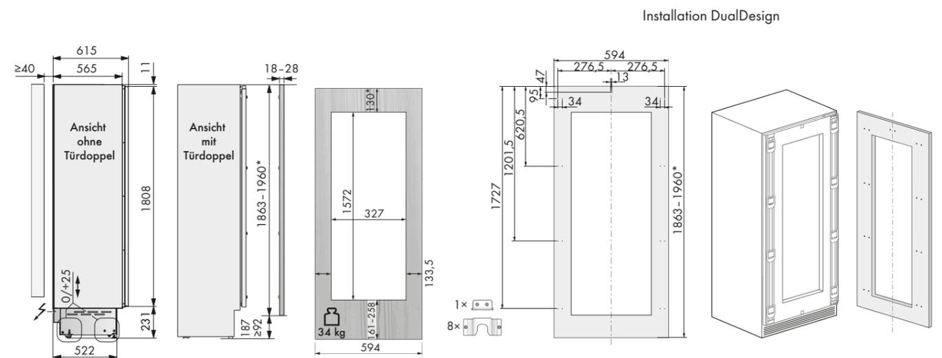
Maximalgewicht Verkleidungspaneele für Türen: 34 Kg
