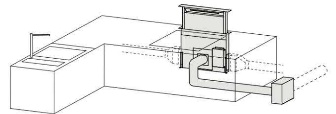
Bei dieser Montagevariante kann der Motor extern, z.B. im Nebenkasten platziert werden. Es wird eine Maximaldistanz von 4 m empfohlen. Der externe Motor darf nur im Innenbereich installiert werden. Der Motor-Einbausatz (Kode1012164) separat bestellen, als Zubehör erhältlich (siehe oben) Der externe Motor kann an die Kanalisierung oder an den Aktivkohlefilter verbunden werden.
