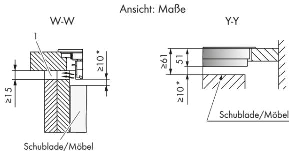
1. FSpalten frei lassen für ausreichende Lüftung Möbelstückbreite 900 mm
