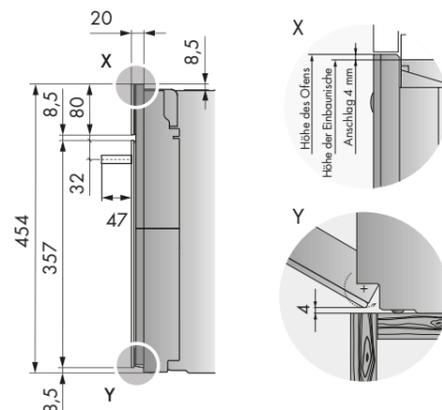
Set mit Halterungen für mehrere Installationen im Säuleneinbau:
