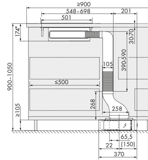
\*170 mm bei Aufgesetzter Montage
