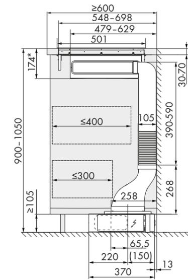
\*170 mm bei aufgesetzter Montage
