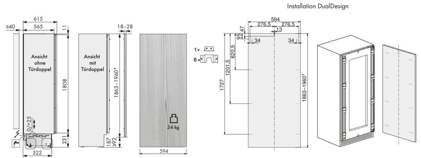
Maximalgewicht Verkleidungspaneele für Türen: 34 Kg
