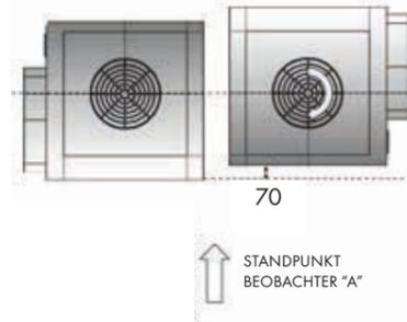
Lüftermotor nach rechts oder nach links drehbar
