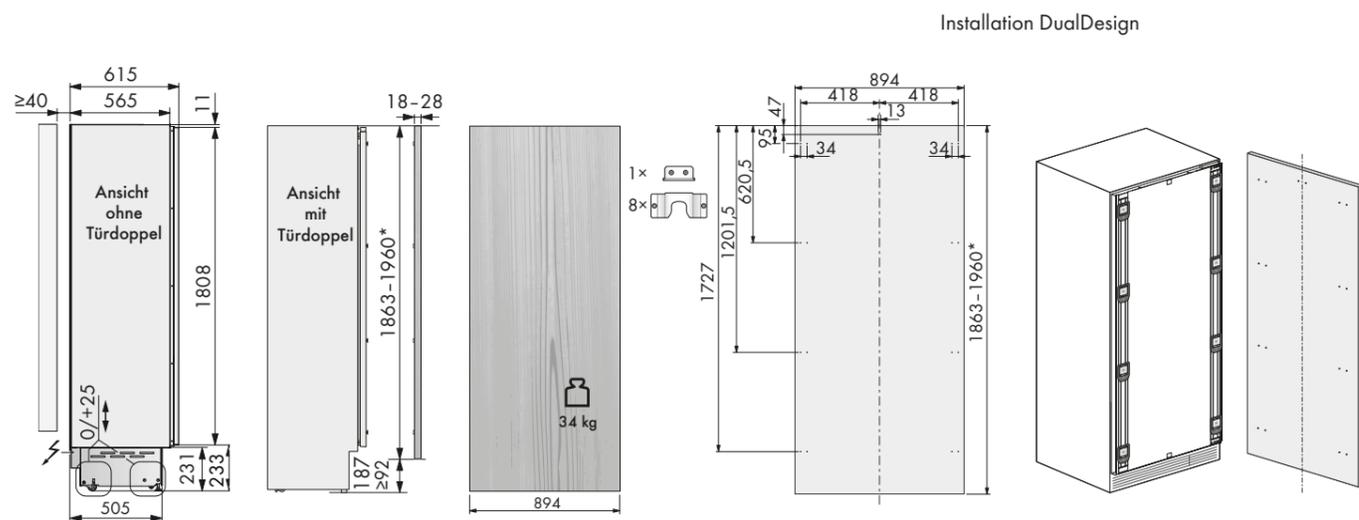
Maximalgewicht Verkleidungspaneele für Türen: 34 Kg
