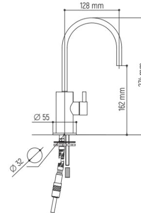
**Sistema filtrazione acqua a osmosi inversa Pure Water da posizionare sotto lo zoccolo della cucina da installare con rubinetto a parete MGS SPIN PF a 1 via affiacato ad un rubinetto a scelta per la gestione dell'acqua di rete**
