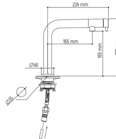
Sistema filtrazione acqua a osmosi inversa Pure Water da posizionare sotto lo zoccolo della cucina da installare con rubinetto MGS SPIN FW a 1 via e rubinetto a scelta per la gestione dell'acqua di rete
