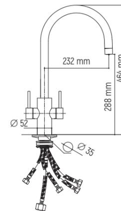
Sistema filtrazione acqua a osmosi inversa Pure Water da posizionare sotto lo zoccolo della cucina da installare con rubinetto MGS Spin DF SP a 3 vie con doccetta laterale
